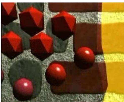
Верхняя часть капилляров забивается кристаллами соли, и вода по капиллярам поднимается после этого уже чуть ниже. Так как в верхней части соль в растворе превращается в сухие кристаллы и закрывает капилляры, поднятие воды уменьшается и в верхней части кристаллов становится больше.
