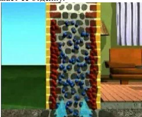
Пропитка стены. Как первый этап борьбы с высолами используется нанесения глубокой пропитки стены паропроницаемым составом KERAKOLL SANABUILD FONDO. Цель этой пропитки – отодвинуть воду внутрь стены.
