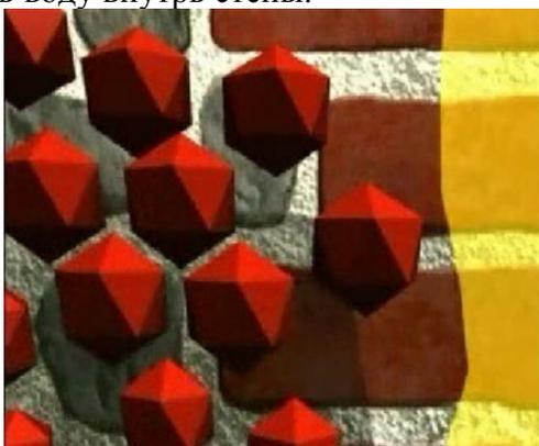
Схема: пропитка уменьшает эффект капиллярного натяжения и не дает воде подойти к поверхности стены. После обработки соль локализуется уже внутри стены, а не на ее поверхности.
